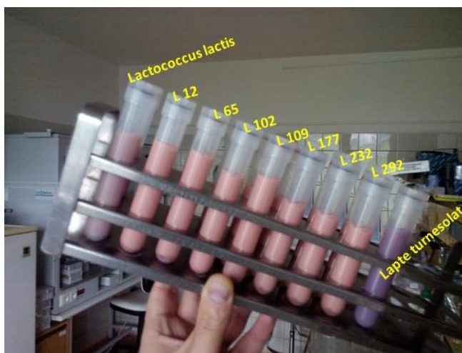
Fig. 3.3. Testul de coagulare/reducere a laptelui turnesolat (Autor foto Cartășev A.).
